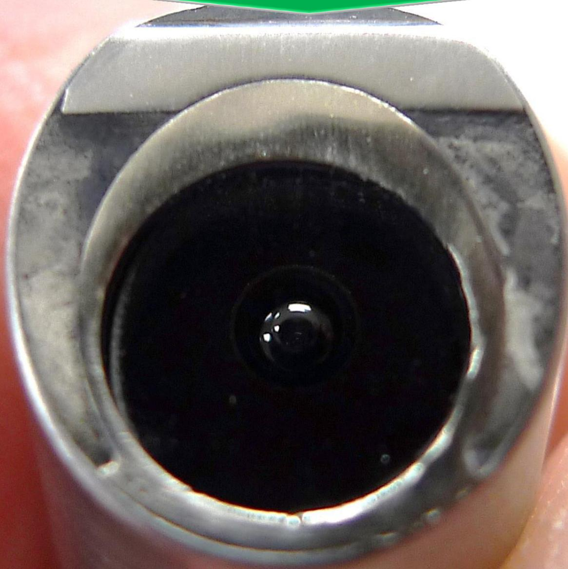
Changement du tube et lentille, soudure à l'argent
