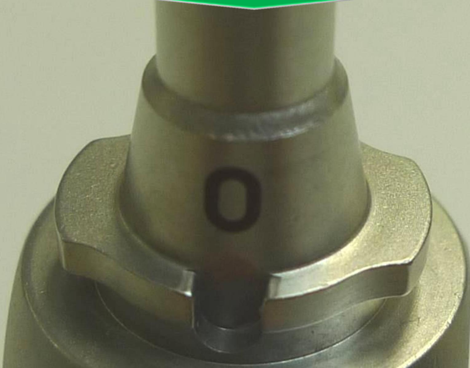
Joint de soudure au laser entre le tube et le boîtier
