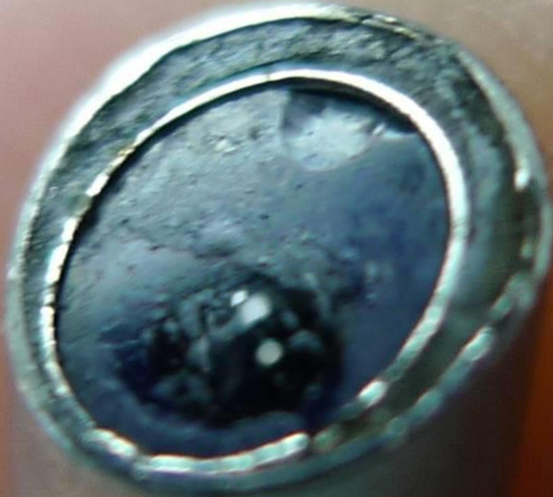
Soudure à l'argent manquante autour de la lentille, bout distal endommagé
