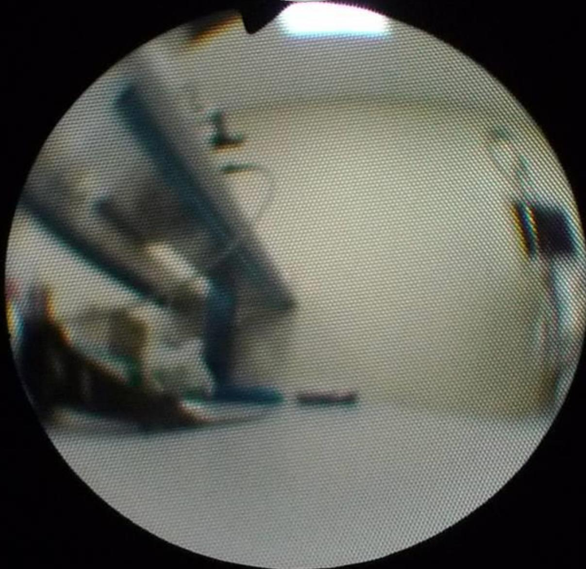
Aucune fibre brisée et aucune invasion de liquide
