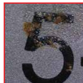
Corrosion par piqûres d'une pincette. Cause : le ruban de couleur étant trop vieux, il permet l'infiltration de substances nocives chlorurées.
