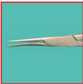
Déformation due à une manipulation non conforme
