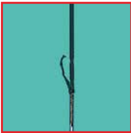
Isolation endommagée d'un instrument HF
