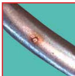
Corrosion par piqûres d'une pincette. Cause : le ruban de couleur étant trop vieux, il permet l'infiltration de substances nocives chlorurées.
