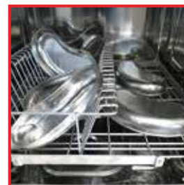
Rangement incorrect, haricots renversés
