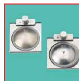
À droite : papillon non étanche d'un trocart par gonflement des joints suite au contact avec de l'huile. À gauche : Nouvelle soupape à clapet
