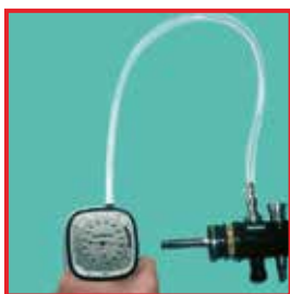
Test d'étanchéité manuel d'un endoscope flexible
