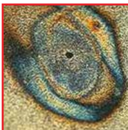
Exemple de corrosion par piqûres
