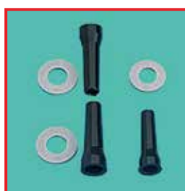
À droite : joints gonflés suite à l'application non ciblée d'huile pour instruments. À gauche : joints neufs
