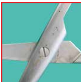
Ciseaux avec corrosion par piqûres
