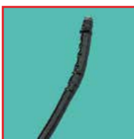
Gonflement d'un flexible d'introduction suite à l'emploi d'un produit d'entretien inadéquat.
