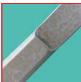
Motif de taches provoqué par l'acide silicique dans le condensat de vapeur.
