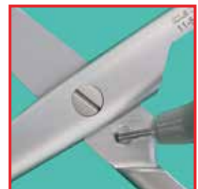
Pour éviter ceci : lubrification ciblée à l'huile pour instruments
