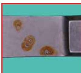
Détail pincette : Transition ressort / Surface de prise. Sels de régénération à forte teneur en chlorure ayant causé une corrosion par piqûres massive sur la surface de l'instrument. Cause : raccord non étanche de l'échangeur d'ions dans le laveur-désinfecteur.
