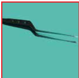
Déformation due à une manipulation non conforme
