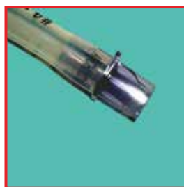
Fissure due à la contrainte
