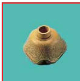
Fissure de vieillissement sur un masque respiratoire
