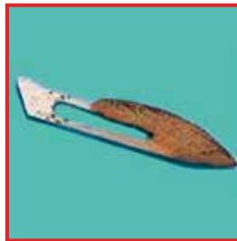
Attaque du matériau de la surface des lames due à l'humidité. Cause : composition du matériau, acier normal car produit à usage unique.
