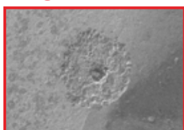
Prise par microscope électronique à balayage, corrosion par piqûre en milieu chloruré
