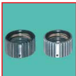
À droite : attaque de l'anodisation noire par l'eau adoucie.
