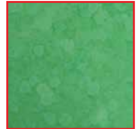
Attaque du matériau de la surface d'aluminium anodisé nature/coloré de conteneurs. Cause : solution de lavage trop fortement alcaline
