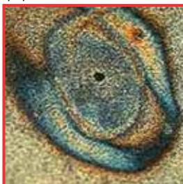
Exemple de corrosion par piqûres
