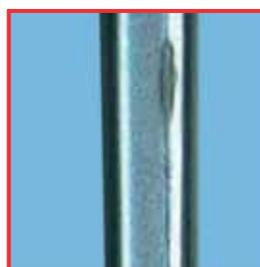
Corrosion de contact :
