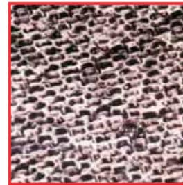
Attaque du matériau d'une poignée en aluminium.
