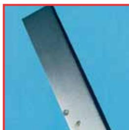
Exemple de corrosion par piqûres
