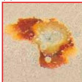
Exemple de corrosion par piqûres
