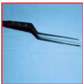
Déformation due à une manipulation non conforme
