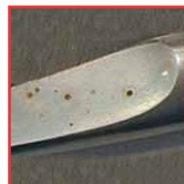
Exemple de corrosion par piqûres
