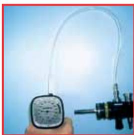
Test d'étanchéité manuel d'un endoscope flexible
