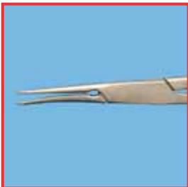
Déformation due à une manipulation non conforme
