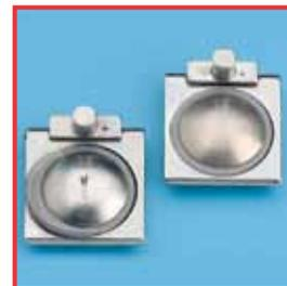
À droite : papillon non étanche d'un trocart par gonflement des joints suite au contact avec de l'huile.
