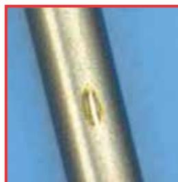
Corrosion de contact :
