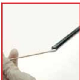
Nettoyage d'un objectif d'endoscope
