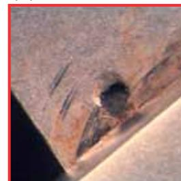
Exemple de corrosion par piqûres
