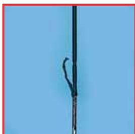
Isolation endommagée d'un instrument HF
