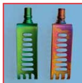
Extrait de valves en titane : Valve de gauche - sortant d'usine. Valve de droite - nettoyée en machine.
